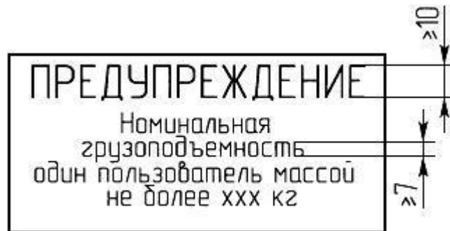
Рисунок 15 - Образец стандартной надписи с информацией о грузоподъемности
