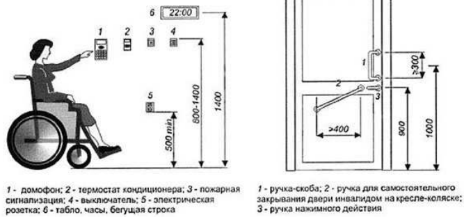
Рисунок Г.6 - Досыгаемость оборудования
