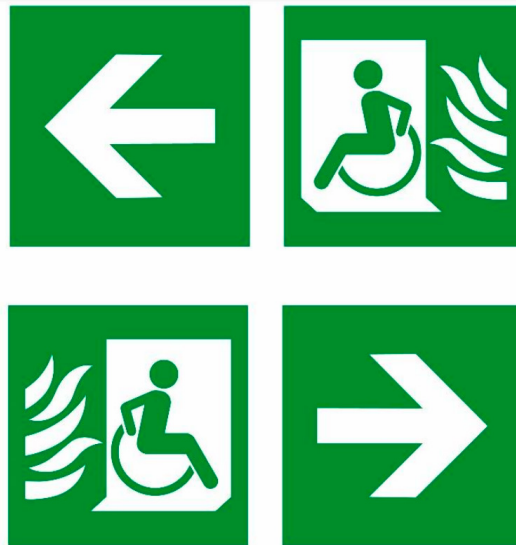
Рисунок 23 — Знак «Эвакуационные пути для инвалидов» («Выход там»)
